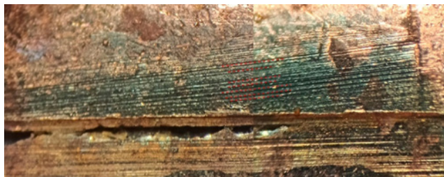
Результат совмещения первичных следов на эталонной пуле (слева) и пуле, находившейся в течение 3 недель в песке с кислотной средой (справа)
