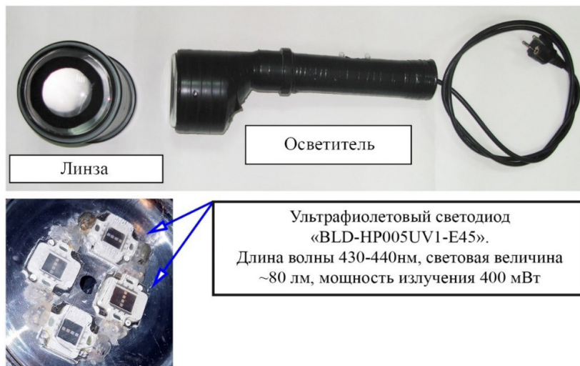
Рис. 1. Сконструированный осветитель, генерирующий оптическое излучение в спектральном диапазоне 430–440 нм
